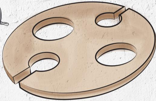
2 Die Aussparungen für zwei Weingläser ( $\varnothing$  6 cm) und eine Flasche ( $\varnothing$  8 cm) mit genügend Abstand zum Rand aussägen. Zusätzlich ca. 2 cm breite Zugänge zu den Glas-Löchern schneiden.
