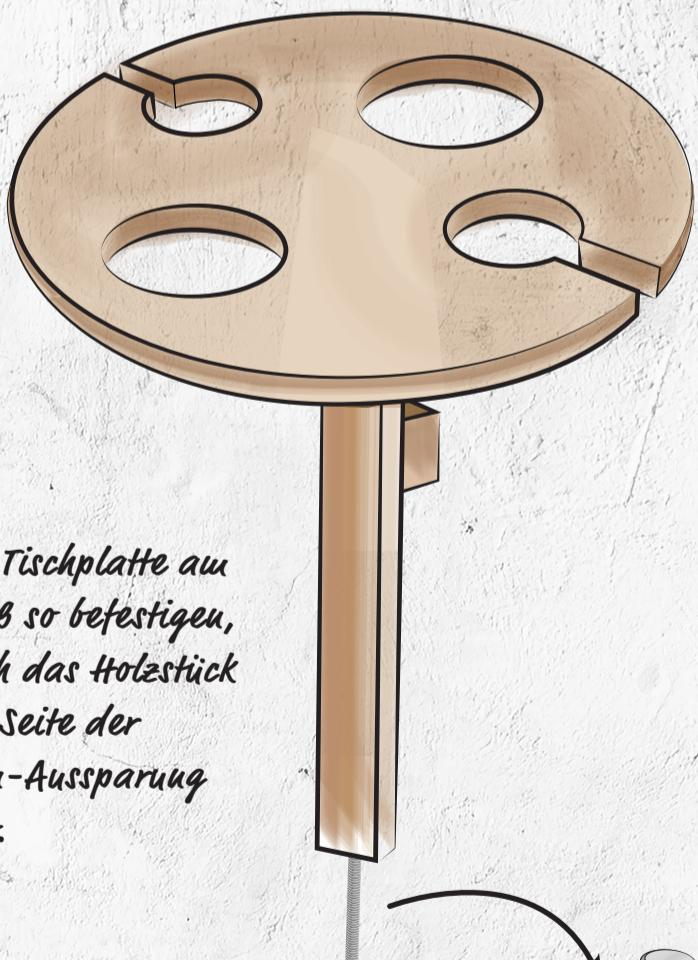
4 Die Tischplatte am Staufuß so befestigen, dass sich das Holzstück auf der Seite der Flaschen-Aussparung befindet.
