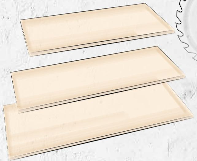
2 Für eine sichere Auflage der Bretter zusätzlich etwas Überstand einkalkulieren und die Bretter auf unterschiedliche Längen zuschneiden.
