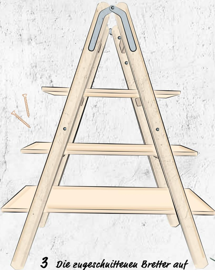
3 Die zugeschnittenen Bretter auf die Trittstufen legen und bei Bedarf mit Holzschrauben befestigen.
