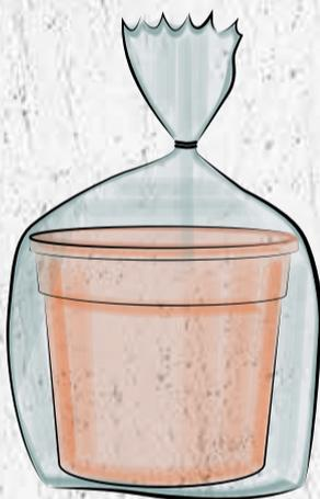
2 Den größeren Behälter mit etwas Speiseöl einreiben. Den kleineren Behälter in die Plastiktüte geben, sodass er nach dem Trocknen leicht herausgezogen werden kann. Die angerührte Masse in den großen Behälter füllen und den kleineren Behälter mittig hineindrücken und mit Steinen o. Ä. beschweren.
