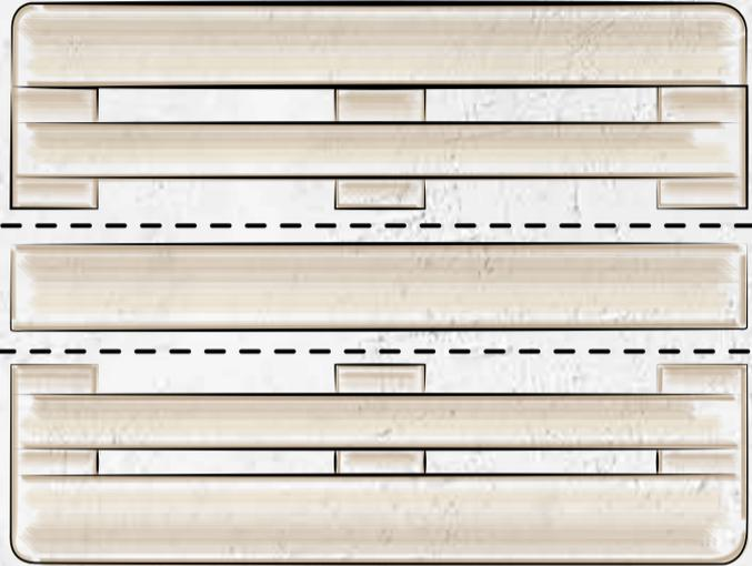
**2** Auf der Vorder- und Rückseite des ausgesägten Stücks die Mitte anzeichnen. In regelmäßigen Abständen je 3x Mittelpunkte für die Bohrlöcher anzeichnen. End- sowie Mittelstück berücksichtigen.
