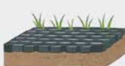
Gitter mit Erde auffüllen und Rasen einsäen
