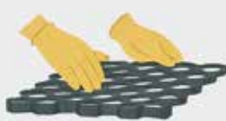
Geovlies verlegen und Kiesschicht aufbringen
