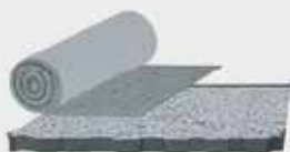
Geovlies verlegen und Kiesschicht aufbringen
