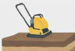
Untergrund ausgleichen und verdichten
