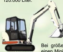
Bei größeren Tanks empfiehlt es sich, für den Aushub einen Minibagger zu verwenden. Beachten Sie, dass dafür eine freie Zufahrt zu der Stelle möglich sein muss, an der Sie Ihren Tank verbauen wollen.
