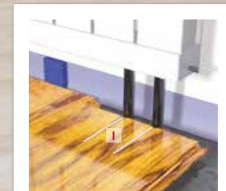
Befestigen Sie Leisten niemals direkt am Boden, damit sich der Boden unter den Leisten ausdehnen oder zusammenziehen kann!
