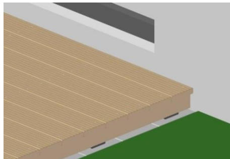
Bild 2. Verlegerichtung parallel zur Fensterfront mit einem Gefälle von 1-2%.
