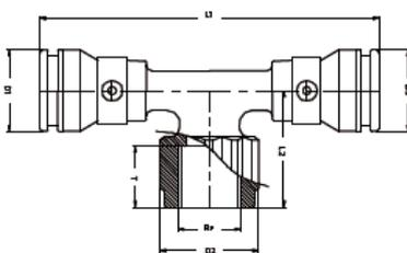
**T-Stück 2-fach Rohranschluss und Innengewinde,**
