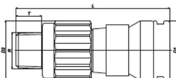
**Kupplung mit Rohranschluss und Außengewinde,**
