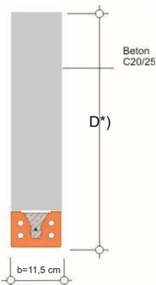
\*) Die Sturzhöhe D wird von Sturzunterkante bis höchstens Oberkante des Deckenrostes angenommen, wenn zwischen Übermauerung und Deckenrost ein einwandfreier Verbund gegeben ist. Andernfalls erstreckt sich die Sturzhöhe D nur bis zur Deckenunterkante.
